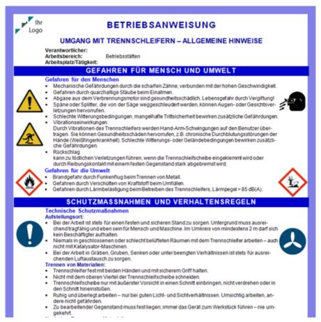
Beispiel einer Betriebsanweisung für den Umgang mit Trennschleifern (Bildquelle: Arbeitshilfen für die Elektrosicherheit)
