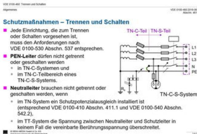
Schutzmaßnahmen: Trennen und Schalten (aus: Schulungsvorlagen für die Elektrotechnik)
