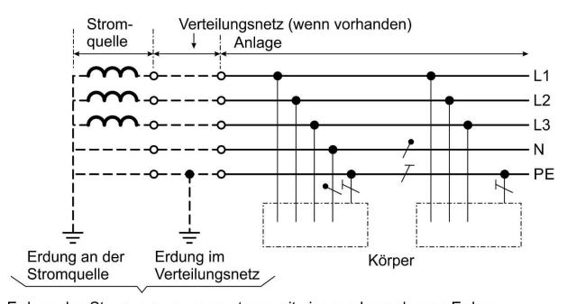
Erdung des Stromversorgungssystems mit einem oder mehreren Erdern
