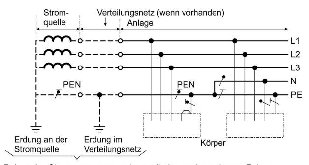
Erdung des Stromversorgungssystems mit einem oder mehreren Erdern
