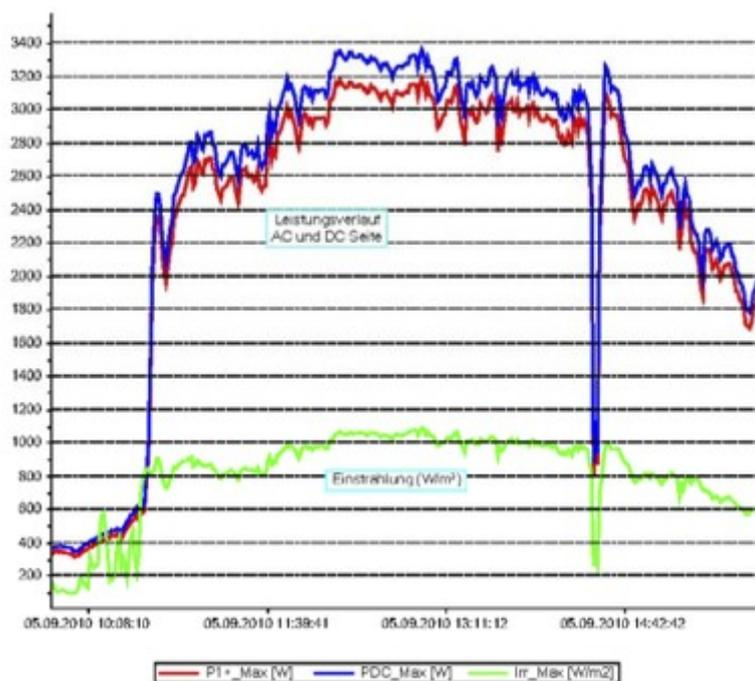
Abb. 6: Leistungsverlauf einer PV-Anlage (Quelle: HT Instruments)
