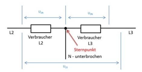
Schaltung bei Neutralleiterunterbrechung mit herausgedrehter Vorsicherung L1
