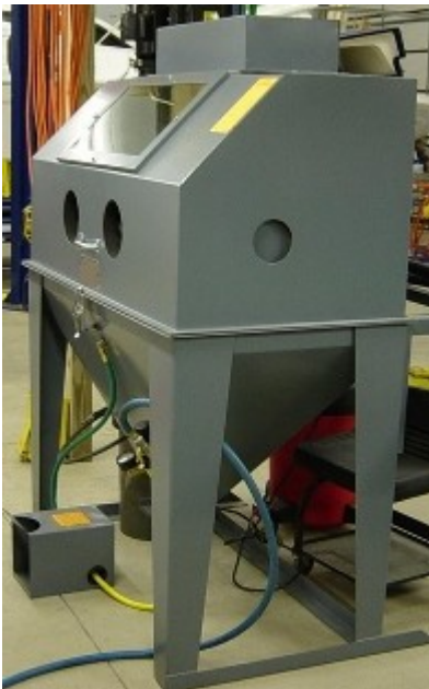
Sandstrahlkabine zur Oberflächenvorbehandlung
