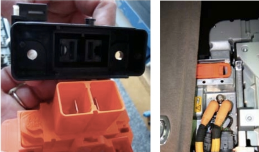
Spezielle Servicestecker für eine sichere Freischaltung (Quelle: DGUV)
