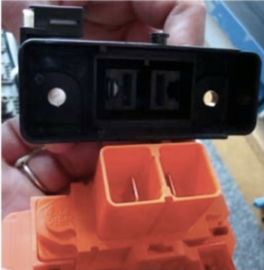
Spezielle Servicestecker für eine sichere Freischaltung (Quelle: DGUV)
