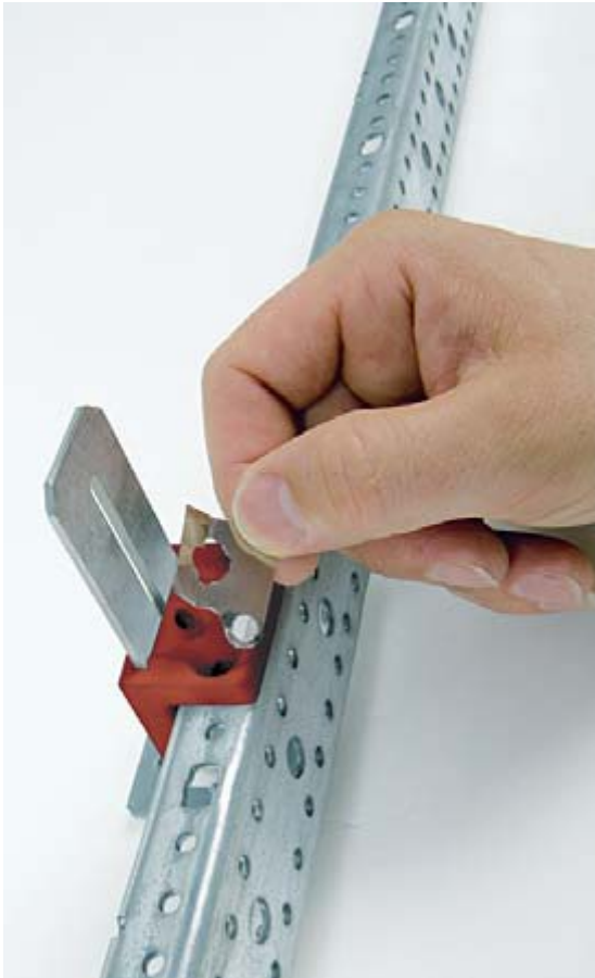
Abb. 3: Bei den neuen Tiefbauwinkeln wird zur schutzisolierten Montage einfach das Metallplättchen entfernt. Es sind keine zusätzlichen Isolierstücke mehr erforderlich. (Foto: Striebel & John)
