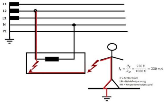
Stromfluss im Falle eines Körperschlusses (Bildquelle: Jörg Belzer, B.Eng.)
