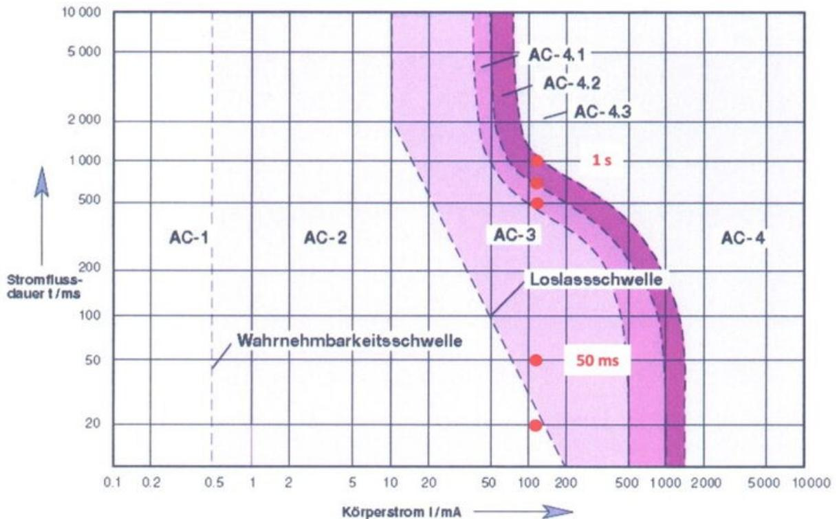
Wirkung des elektrischen Stroms in Abhängigkeit von der Dauer des Einwirkens (Bildquelle: Jörg Belzer, B.Eng., MBA)
