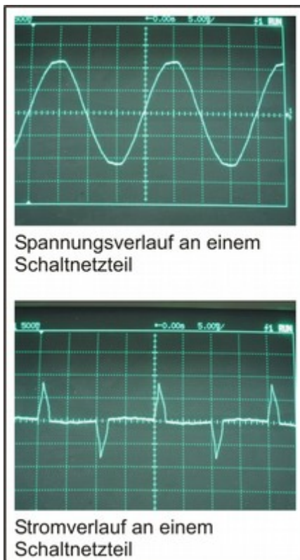
Spannungs- und Stromverlauf am Betriebsspannungseingang eines Computers
