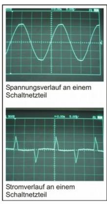
Spannungs- und Stromverlauf am Betriebsspannungseingang eines Computers
