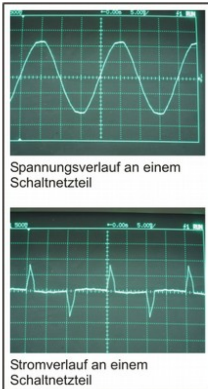
Spannungs- und Stromverlauf am Betriebsspannungseingang eines Computers
