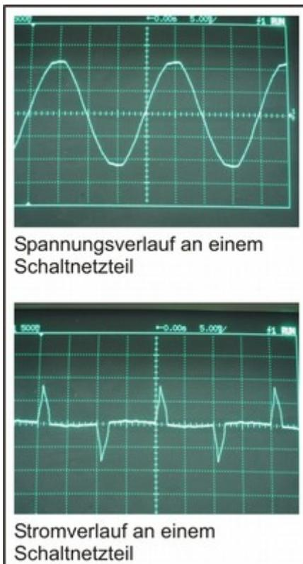
Spannungs- und Stromverlauf am Betriebsspannungseingang eines Computers
