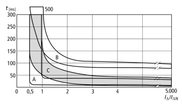
Abb. 6: Auslösekennlinien von unverzögerten (A), verzögerten, selektiven (B) und kurzzeitverzögerten (C) Fehlerstrom-Schutzschaltern
