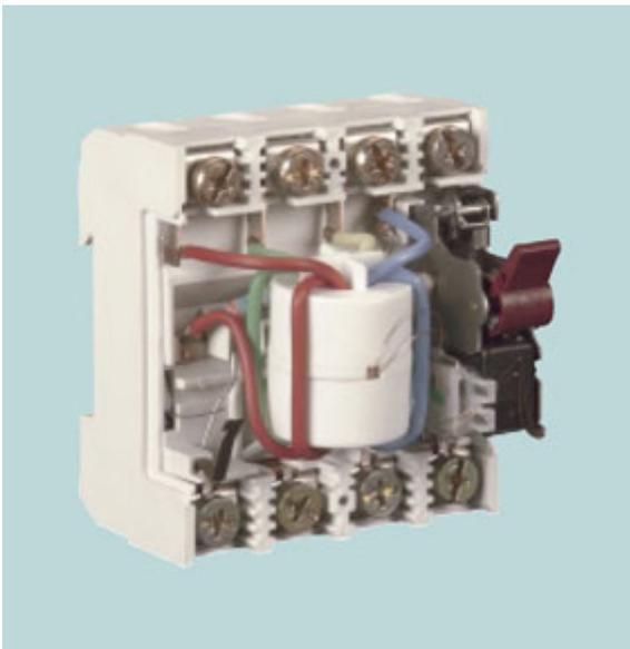
Abb. 1: Innenansicht eines Fehlerstrom-Schutzschalters mit Primärleitungen, Summenstromwandler, Auslöserelais und Schaltmechanismus
