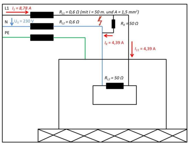
Abb. 1: Zustand nach Entstehung eines unvollkommenen Kurzschlusses
