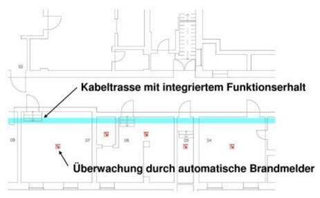
Abb. 1: Überwachung einer Leitungsanlage mit integriertem Funktionserhalt
