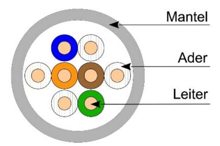
Abb. 1: Aufbau einer TP-Leitung
