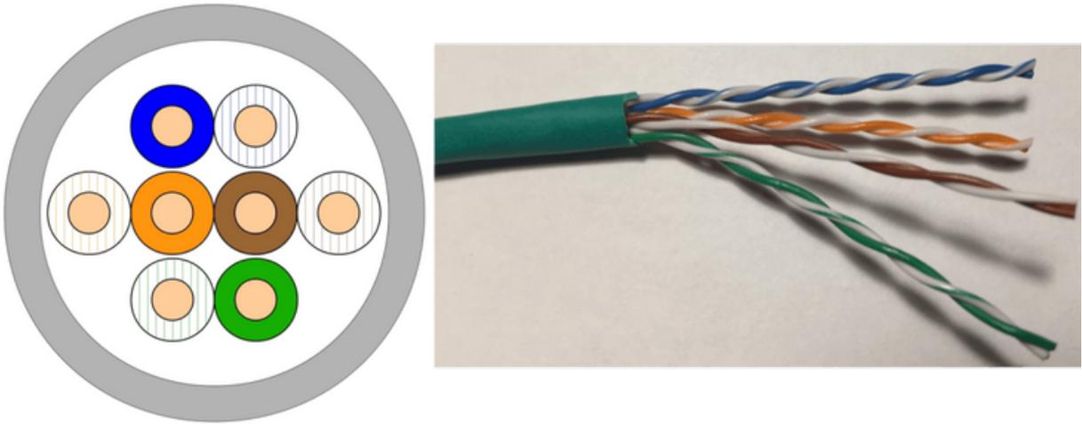
Abb. 2: U/UTP - Twisted Pair-Leitung ohne jegliche Schirmung
