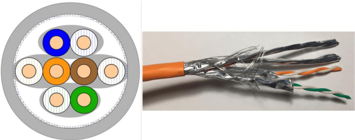
Abb. 3: S/FTP - Twisted Pair-Leitung mit Gesamtschirm und Einzelpaarschirm
