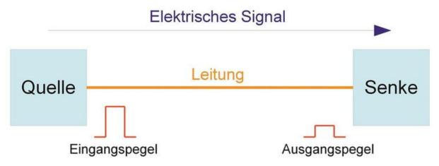
Abb. 1: Modell der leitungsgebundenen Übertragung
