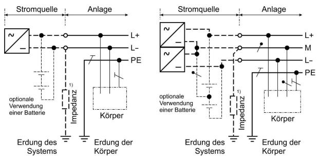
Das System darf mit Erde über eine ausreichend hohe Impedanz verbunden sein. Eine solche Erdung darf nur für Mess- oder Funktionszwecke angewandt werden.
