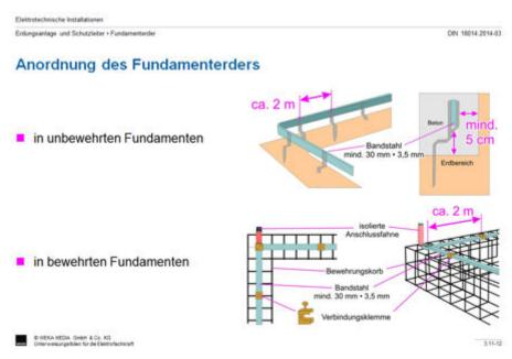
Abb. 2: Anordnung des Fundamenterders (Bildquelle: Unterweisungfolien für die Elektrofachkraft)
