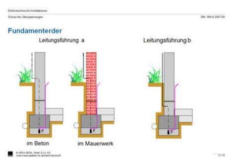
Abb. 1: Fundamenterder: Verlegung und Leitungsführung (Bildquelle: Unterweisungfolien für die Elektrofachkraft)
