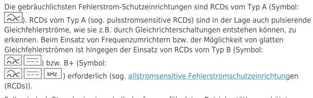
Sollen jedoch Stromkreise innerhalb der feuergefährdeten Betriebsstätte geschützt werden, deren Betriebsstrom größer ist als der Bemessungsstrom des RCDs, so müssen andere Varianten zur Anwendung kommen.
