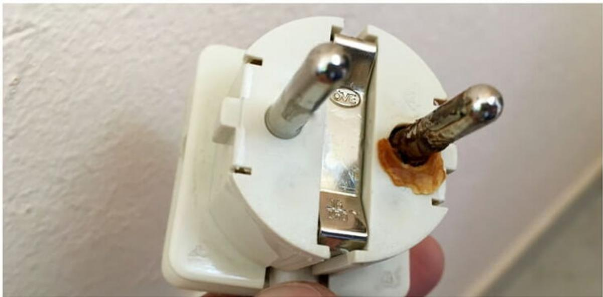
Steckdose und Stecker, die aufgrund hochohmiger Kontaktierung thermisch überlastet wurden.
