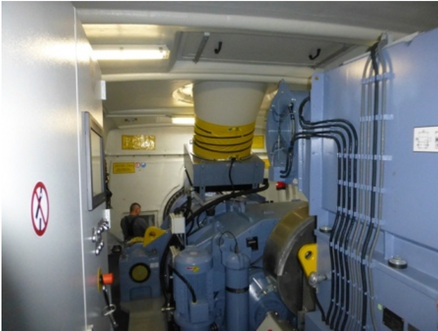
Abb. 3: Maschinenhaus einer Multimegawatt-Windenergieanlage
