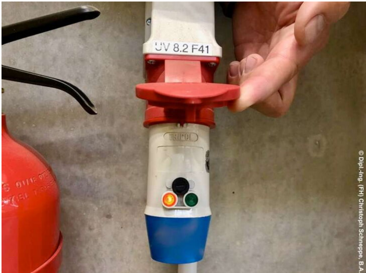
CEE-Steckdosen Adapter zur Feststellung der Drehfeldrichtung
