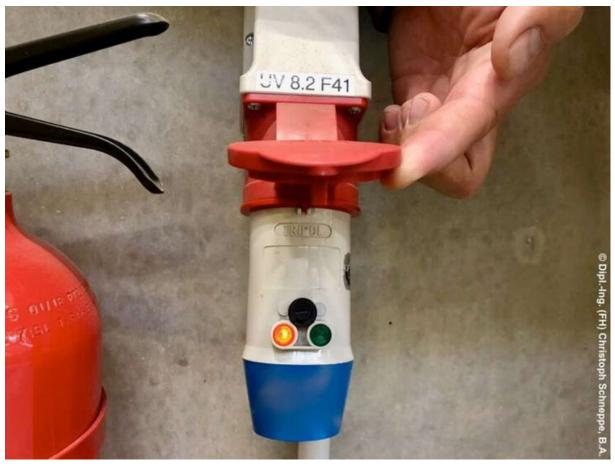
CEE-Steckdosen Adapter zur Feststellung der Drehfeldrichtung
