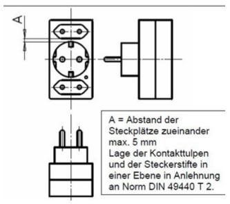
Konformer Adapter mit Schutzkontaktsteckplatz
