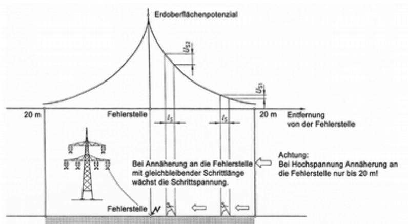
Abb. 2: Schrittspannung  $U_s$  im Bereich einer Fehlerstelle bei der Schrittweite  $L_s$
