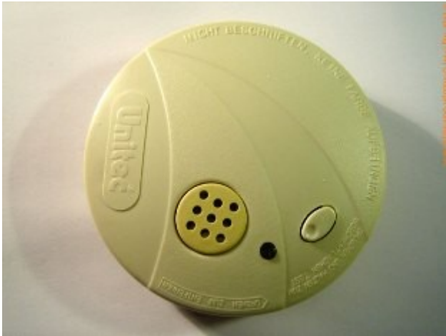
Automatischer Brandmelder (optischer Rauchmelder)
