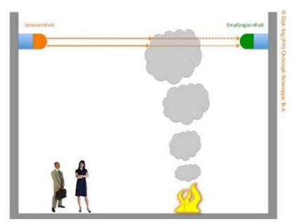
Wirkprinzip eines Lichtstrahlrauchmelders
