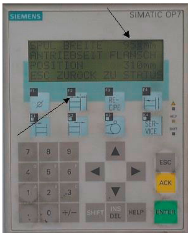
Durch die Eingabe der Spulenbreite mit F2 am OP7 wird die Größe des Überwachungsbereichs festgelegt
