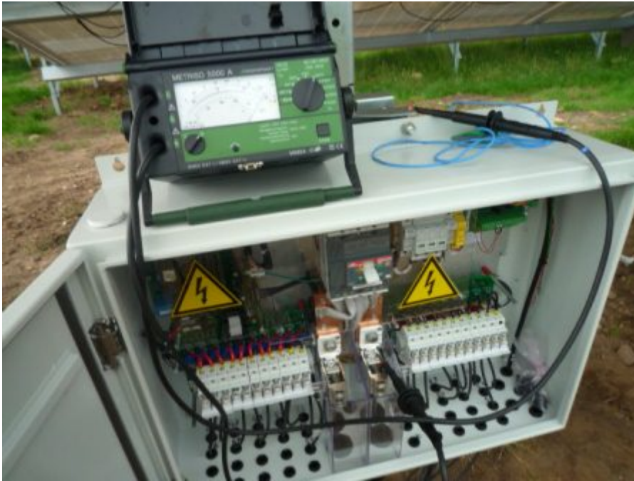
Abb. 1: Isolationsmessung am Generatoranschlusskasten (Quelle: Fa. K&S, www.krugundschräm.de )
