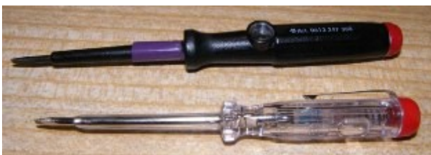
Abb.: Typische einpolige Spannungsprüfer nach DIN VDE 0680-6
