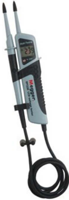
Abb.: Typischer zweipoliger Spannungsprüfer
