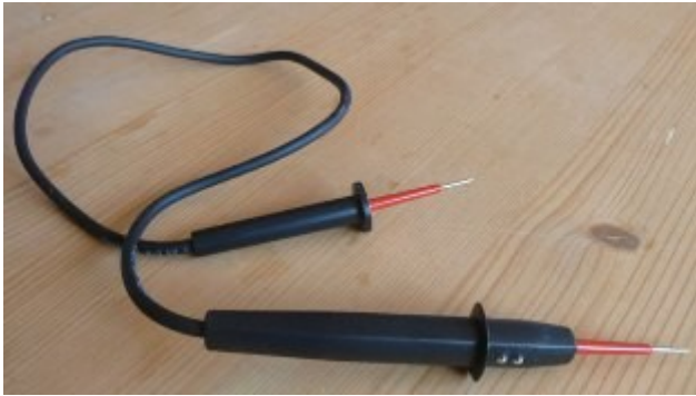
Abb.: Zweipoliger Spannungsprüfer nur mit CAT II
