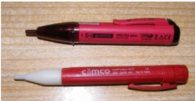
Abb.: Typischer berührungsloser Spannungsprüfer
