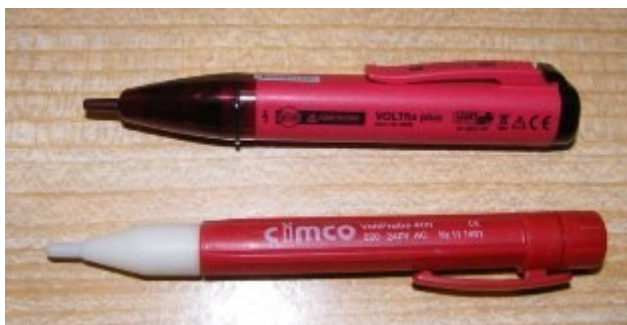
Abb.: Typischer berührungsloser Spannungsprüfer
