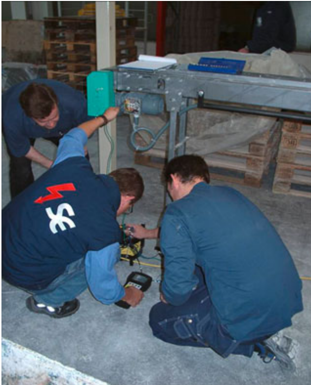
Abb. 3: Kleine elektrische Maschine, die nach DIN VDE 0701-0702 geprüft werden könnte
