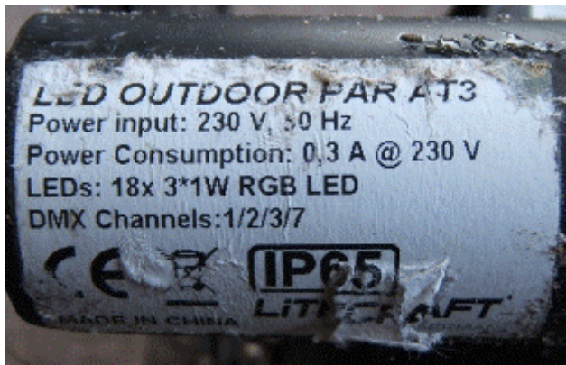
Beispiel für ein schlechtes Typenschild: Es ist nicht ausreichend beständig gegenüber den zu erwartenden Witterungseinflüssen (IP 65)
