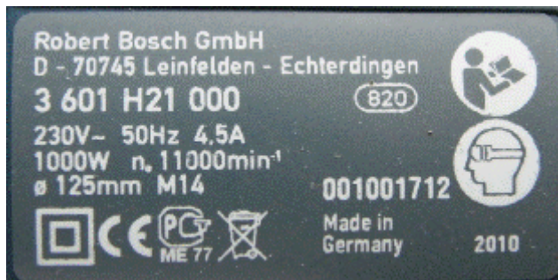
Beispielhaftes Typenschild eines Winkelschleifers nach DIN VDE 0740-2-3
