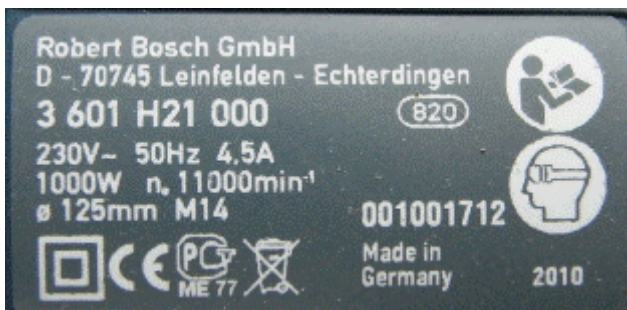
Beispielhaftes Typenschild eines Winkelschleifers nach DIN VDE 0740-2-3
