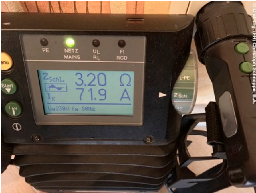
Unzureichender Schleifenimpedanz-Messwert an einem Steckdosenstromkreis (Bildquelle: Dipl.-Ing. (FH) Christoph Schneppe, B.A.)
