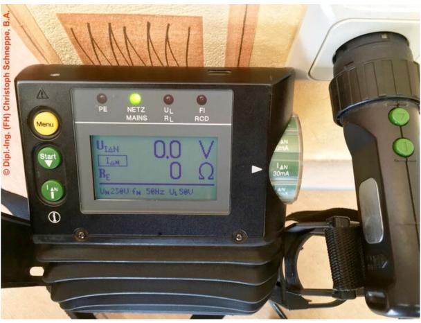
Messung der Berührungsspannung an einem Steckdosenstromkreis mit Fehlerstrom-Schutzeinrichtung (RCD)
