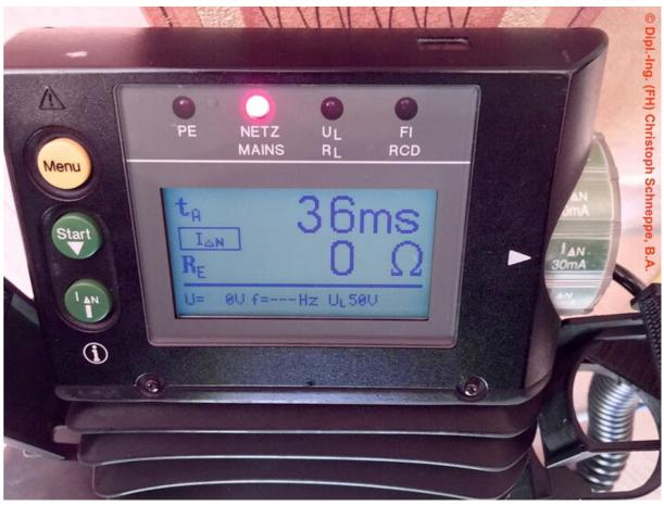
Messung der Auslösezeit an einem Steckdosenstromkreis mit Fehlerstrom-Schutzeinrichtung (RCD)
