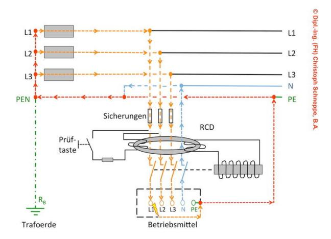
Prinzipbild eines fehlerbehafteten Stromkreises mit Fehlerstrom-Schutzeinrichtung (RCD)
