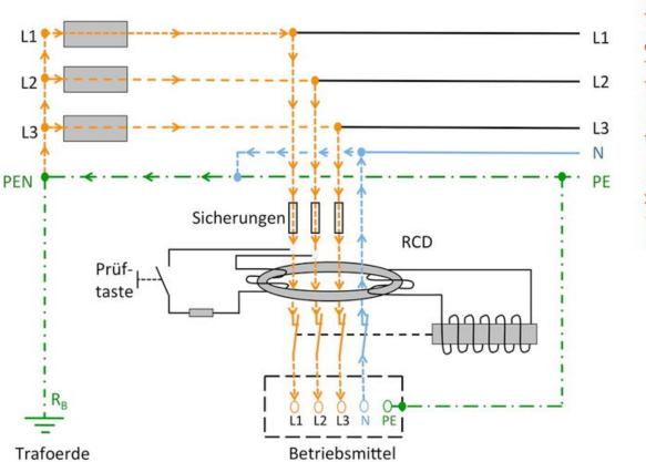
Prinzipbild eines intakten Stromkreises mit Fehlerstrom-Schutzeinrichtung (RCD)
