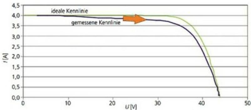
Abb. 8: Kleiner Parallelwiderstand, z.B. durch Anpassungsverlust (Quelle: PVE)
