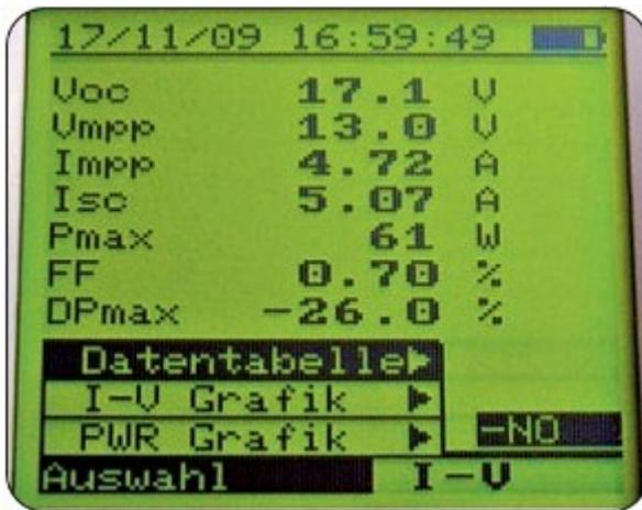
Abb. 4: Angezeigte Messwerte des Kennlinienmessgeräts (Quelle: HT Instruments)
