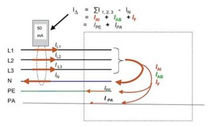
Abb. 2: Differenzstrommessung an der Einspeisung eines Drehstrom-Stromkreises. Darstellung der Zusammensetzung eines "Differenzstroms" aus den Ableit- und Fehlerströmen der angeschlossenen Geräte (Stromwert als Beispiel, geometrische Addition)
