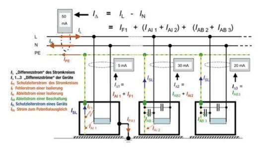
Abb. 1: "Differenzströme" in einem Wechselstrom-Stromkreis. Beispielhafte Darstellung von Varianten der möglichen Zusammensetzung dieses "Differenzstroms" aus den Ableit- und Fehlerströmen der angeschlossenen Geräte und ihrer Werte.
