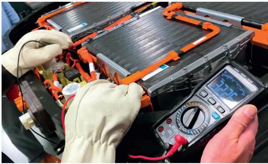
Spannungsmessung bei einer Elektroautobatterie
