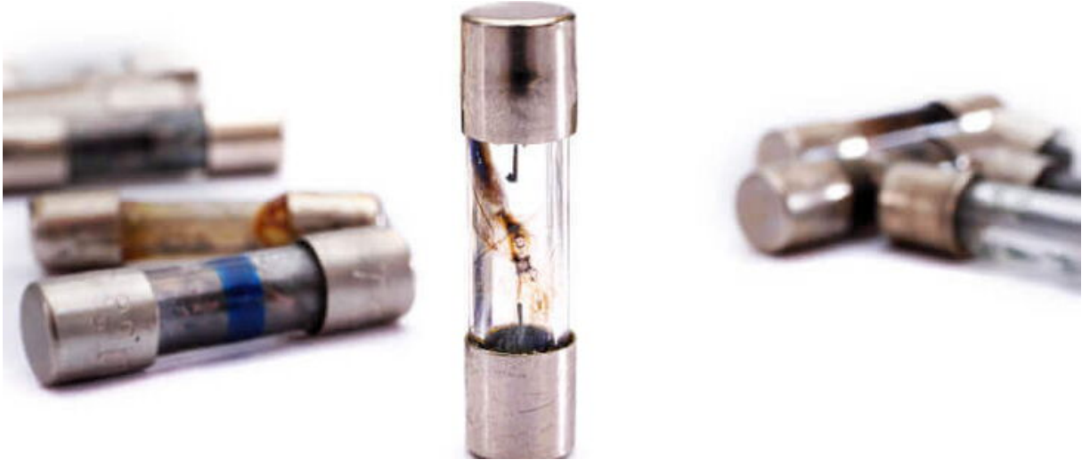
Durchgeschmorter Schmelzleiter in einem Schmelzeinsatz (Bildquelle: asadykov/iStock/Getty Images Plus)
