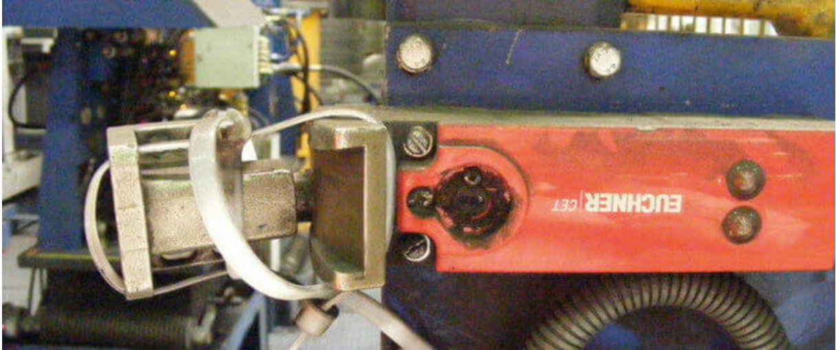
Loses Schaltelement mit Kabelbinder an Sicherheitsschalter gebunden (Bildquelle: Jürgen Bialek/Kommentar zur Maschinenrichtlinie WEKA)
